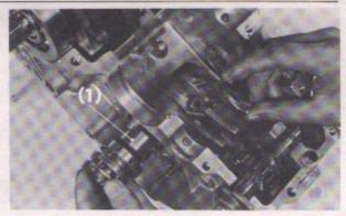
Fig. 3-42 (1) Gear shift drum
